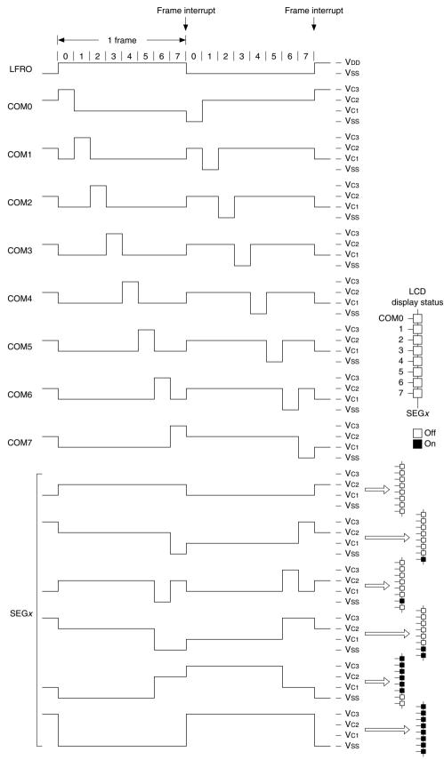
Figure 23.4.2.1 1/8 Duty Drive Waveform
