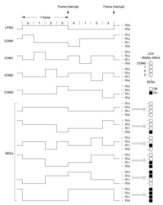
Figure 23.4.2.2 1/4 Duty Drive Waveform
