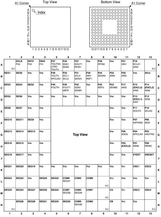
Figure 1.3.4.2 S1C17602/621 Pin Configuration Diagram (VFBGA7H-144, Top View)
